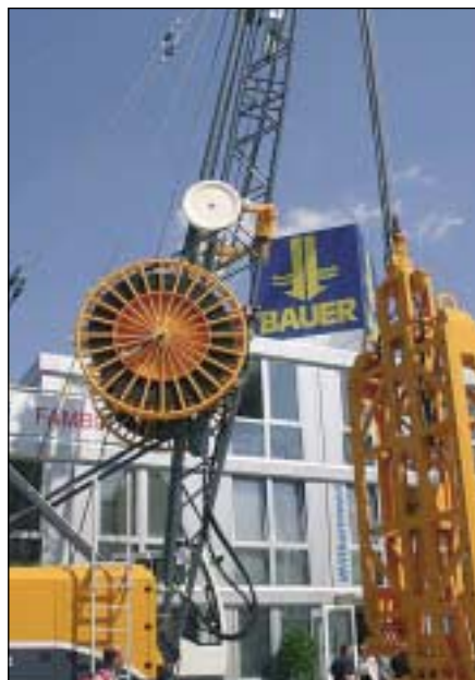
Carro di perforazione BG 24 H con prolunga mast tralicciato e accessorio per infissione pali
