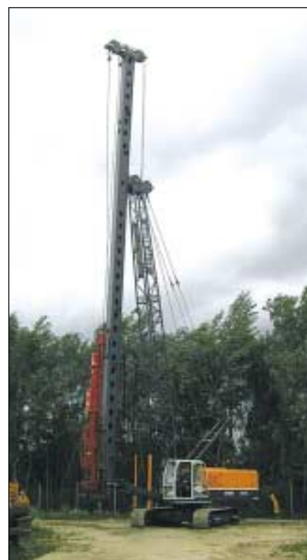
MC 32 con mast guida BL 25 e battipalo diesel Pileco
