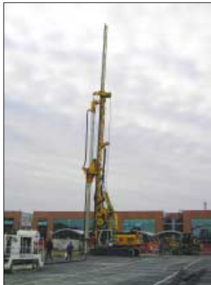
Carro di perforazione BG 24 H con prolunga mast tralicciato e accessorio per infissione pali
